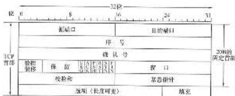
图 2 TCP 段头结构
