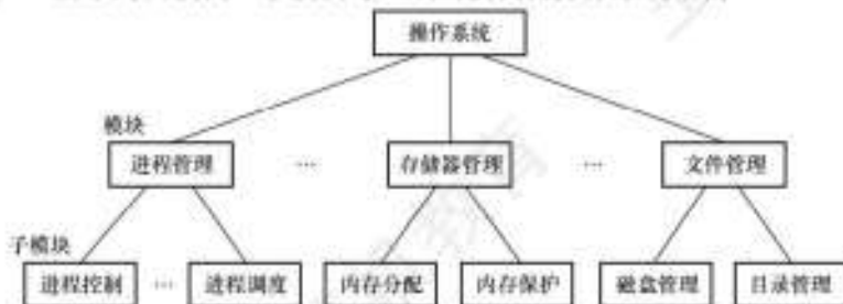
图 1.5 由模块、子模块等组成的模块化操作系统结构
