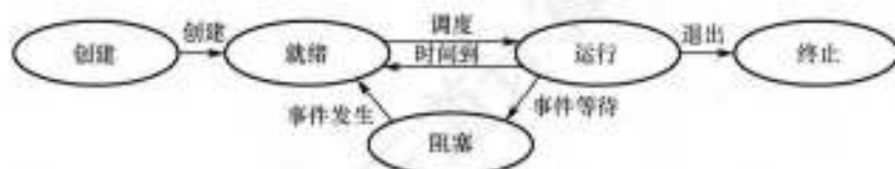
图 2.1 5 种进程状态的转换
