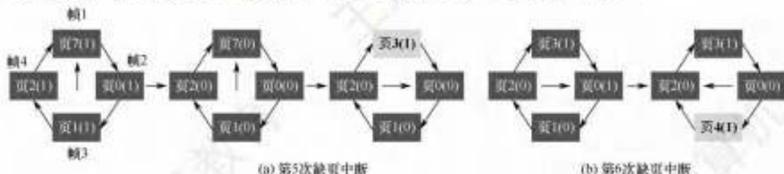
图 3.27 缺页中断时替换指针扫描示意图
