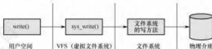
图 4.25 write() 系统调用操作示意图
