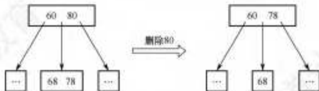
图 7.30 B 树中删除非终端结点关键字的取代
