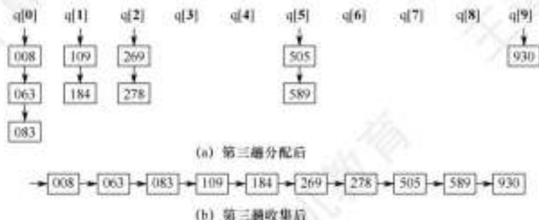
图 8.12 第三趟链式基数排序操作
