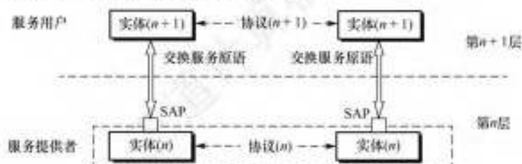
图 1.9 协议、接口、服务三者之间的关系
