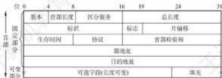
题 10 图 IPv4 数据报的首部格式
