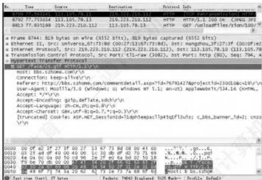
图 6.15 用 Wireshark 捕获的一个 HTTP 请求报文
