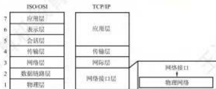
图 1.14 TCP/IP 模型与 OSI 参考模型的层次对应关系
