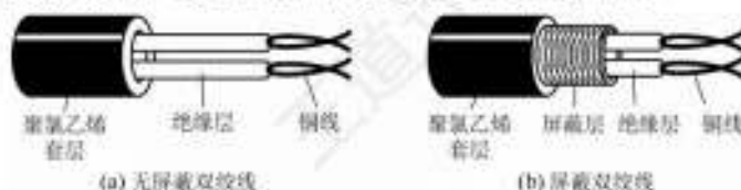
图 2.4 双绞线的结构
