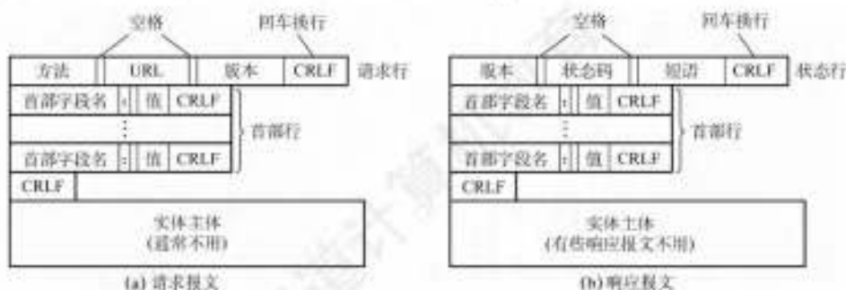
图 6.14 HTTP 的报文结构
