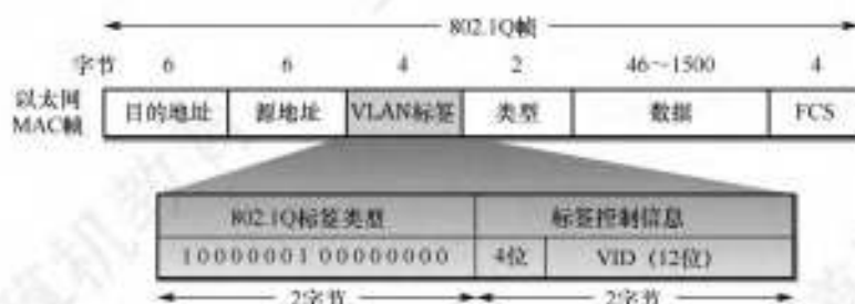
图 3.30 插入 VLAN 标签后变成了 802.1Q 帧
