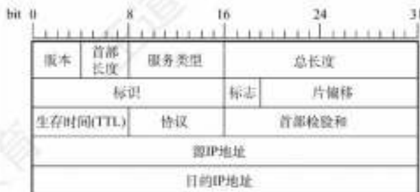
图 1 IP 分组头结构
