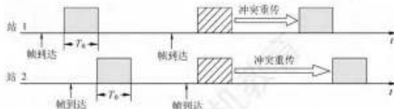
图 3.20 时隙 ALOHA 协议的工作原理
