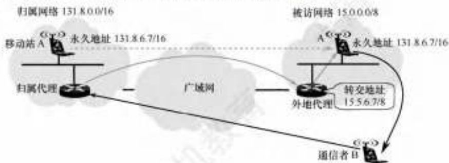
图 4.22 移动 IP 的基本通信过程
