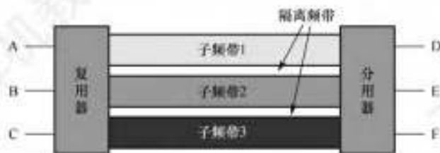
图 3.17 频分复用的原理示意图
