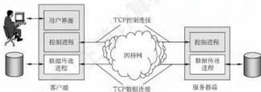
图 6.7 控制连接和数据连接
