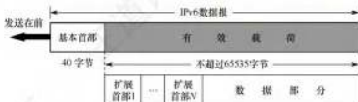
图 4.11 具有多个可选扩展首部的 IPv6 数据报的一般形式
