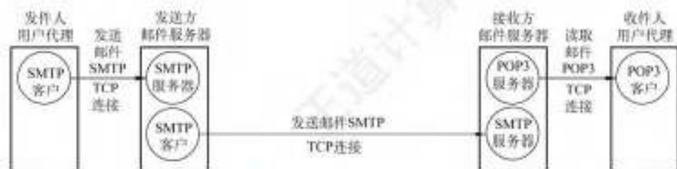
图 6.8 电子邮件系统最主要的组成构件
