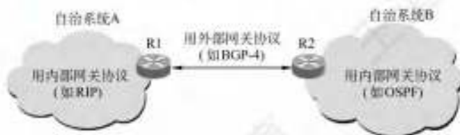
图 4.15 自治系统和内部网关协议、外部网关协议
