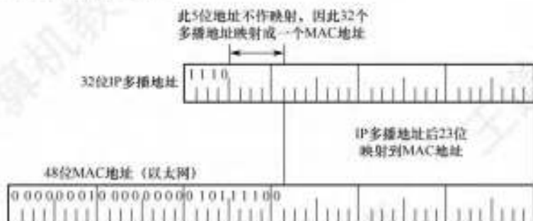
图 4.21 D 类 IP 地址与以太网多播地址的映射关系
