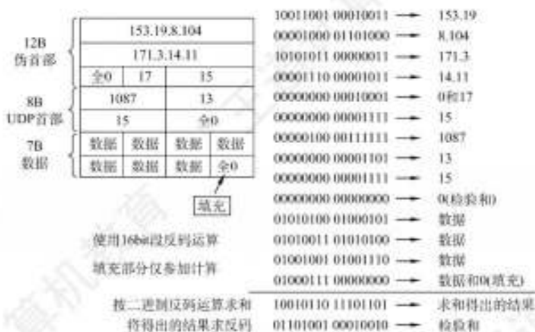
图 5.5 计算UDP校验和的例子
