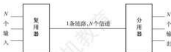
图 3.16 复用原理示意图
